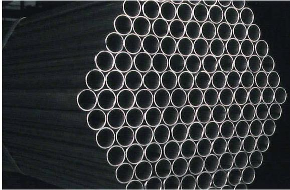
高周波誘導溶接法ですので、高周波電流の表皮効果および近接効果により、電流が溶接部に集中します。そのために溶接性が良く、鋼管全長にわたって信頼性の高い溶接部が確保されます。
